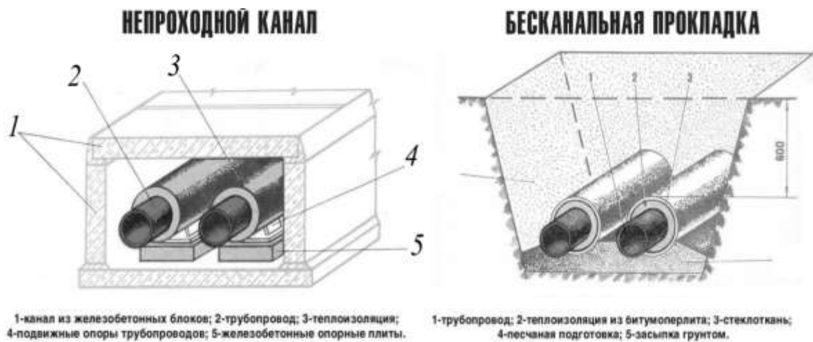
Рис. 35. Канальная и бесканальная прокладка тепловой сети
