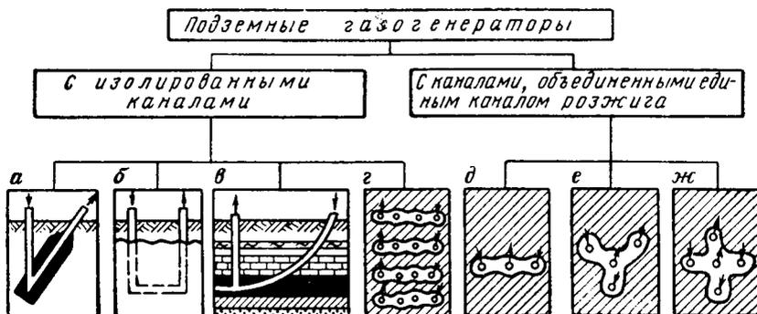
Рис. 6.21. Конструкции подземных газогенераторов
