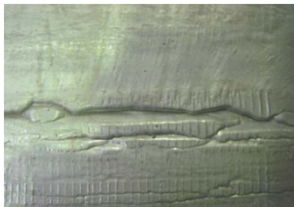
Рис. 1.35. Неслитина на широкой грани плоского слитка
