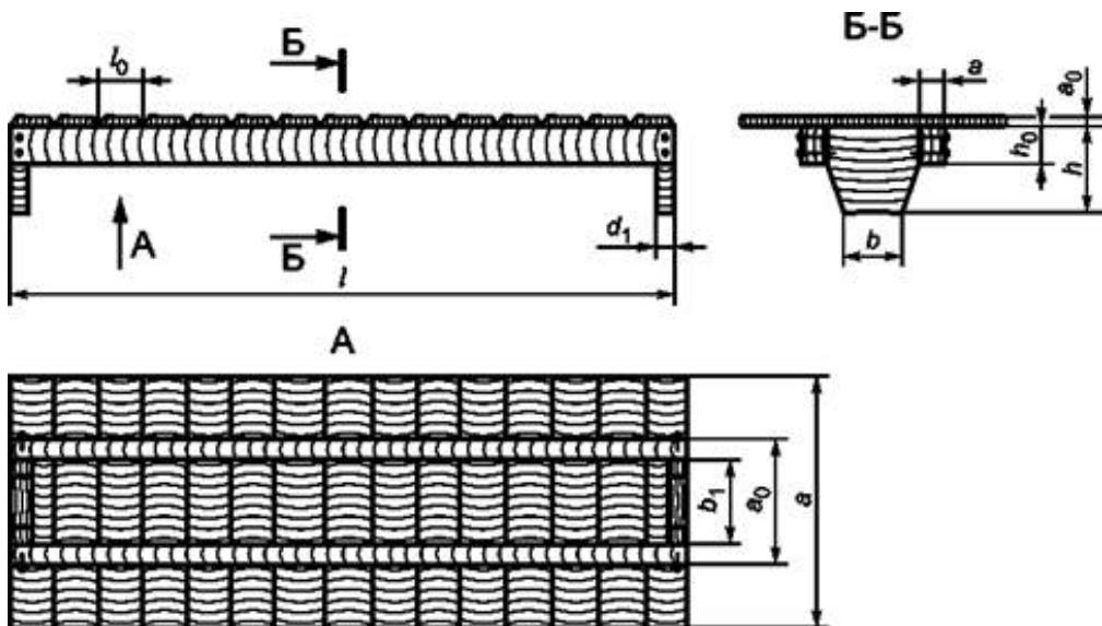
Рис. 37. Полка сланцевого заслона со свободнолежащим настилом
