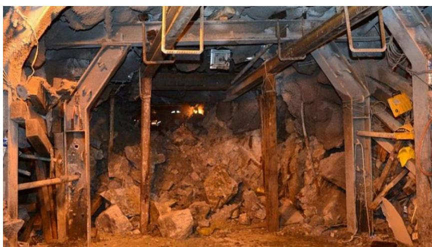
Рис. 1. Обрушение горных выработок
