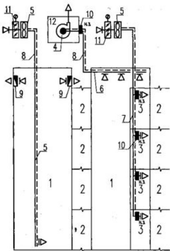
Рис. 30. Принципиальные схемы систем противодымной вентиляции в изолированных рампах: 1 — рампа; 2 — этажи стоянок автомобилей; 3 — тамбур-шлюзы; 4 — вентилятор дымоудаления; 5 — вентилятор подпора; 6 — воздуховод вытяжной системы противодымной вентиляции; 7 — воздуховод приточной системы противодымной вентиляции; 8 — воздуховод с нормируемым пределом огнестойкости; 9 — дымовой клапан; 10 — противопожарный клапан; 11 — морозостойкий клапан; 12 — помещение для вентиляционного оборудования
