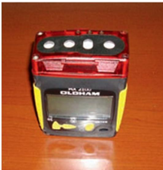
Рис. 7. Мультигазоанализатор
