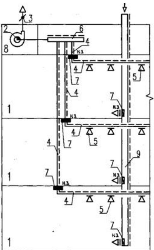
В подземных многоэтажных автостоянках с целью обеспечения эффективной работы систем дымоудаления следует проектировать шахты для естественного поступления наружного воздуха на этаж пожара. При размещении венткамеры в другом пожарном отсеке следует у стены (или в стене) венткамеры установить противопожарный нормально закрытый клапан.
