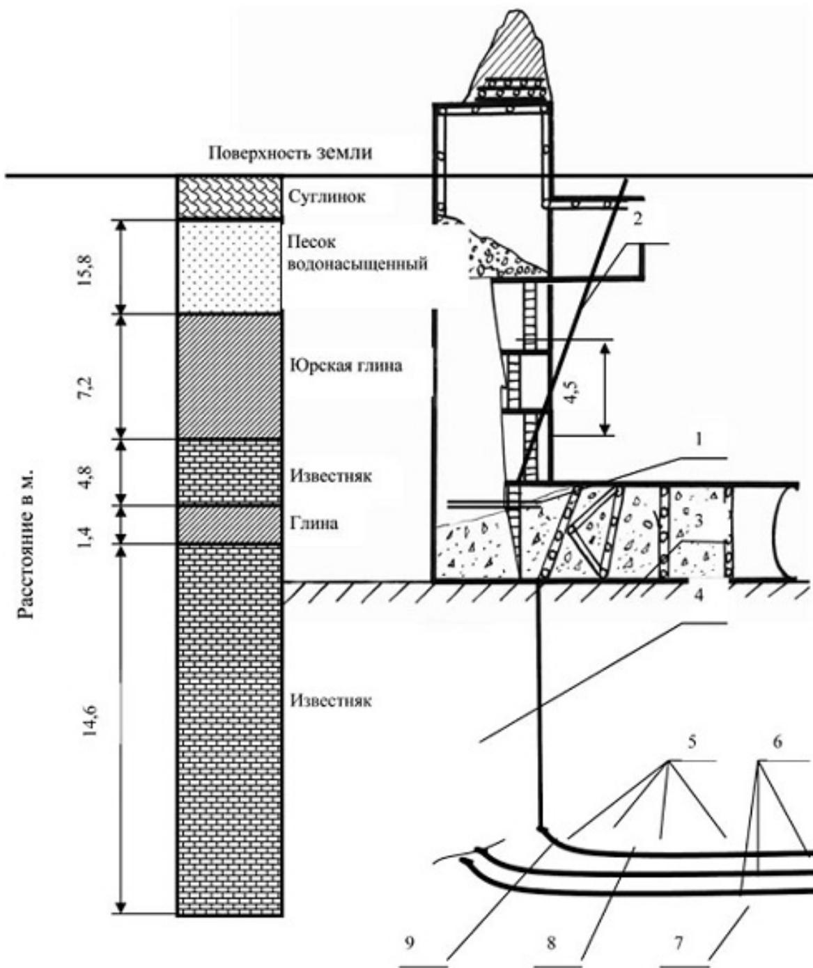
Рис. 2. Схема аварийного участка выработки: 1 — рабочий полок (восстановлен для возведения костровой крепи в куполе); 2 — скважина с поверхности для подачи бетонного раствора; 3 — верхняя штольня; 4 — фурнель (участок обетонированной крепи); 5 — перемычки; 6 — трубопроводы; 7 — подходная выработка; 8 — бетон; 9 — забутовка
