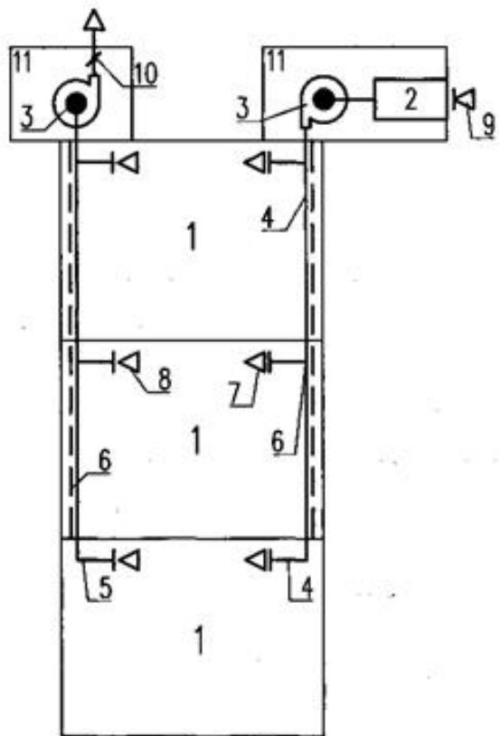
На схеме рис. 26 показаны помещения венткамер в одном пожарном отсеке с рампой; если венткамера расположена в другом пожарном отсеке, необходимо в системе у выхода из венткамеры установить противопожарный нормально открытый клапан. Если в одной венткамере размещены вентиляционные установки, обслуживающие помещения стоянок автомобилей и рампы, в каждой системе также должны быть установлены противопожарные нормально открытые клапаны.
