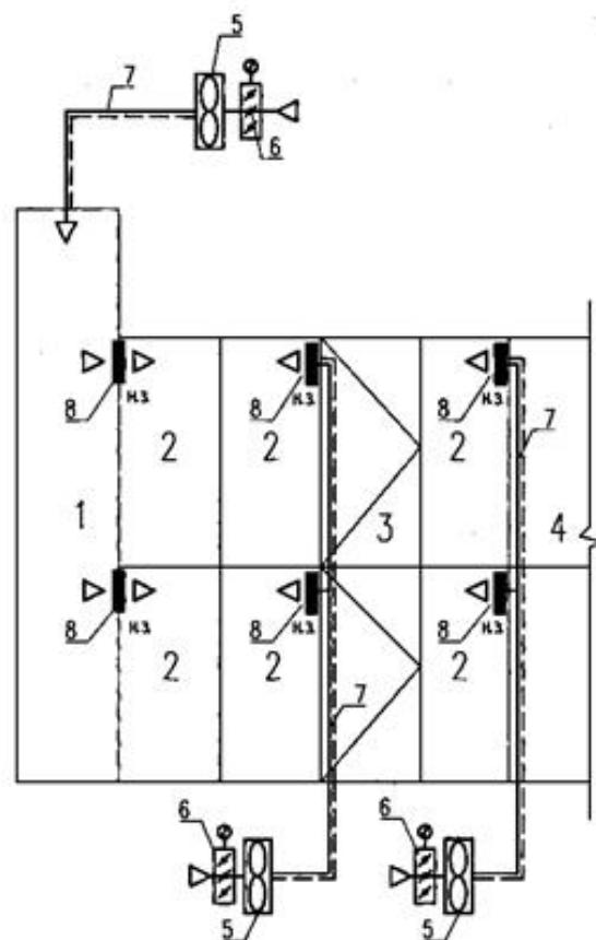
На воздухозаборе приточных противодымных систем желательно ставить морозостойкий приточный клапан, лопатки которого не примерзают при низких температурах и повышенной влажности.
