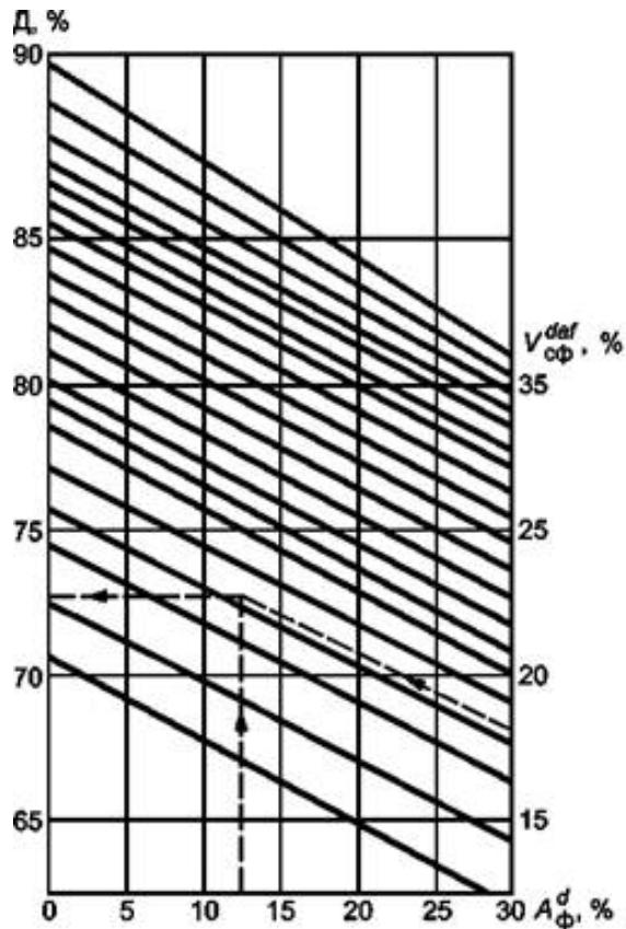
Рис. 39. Номограмма для определения добавки инертной пыли ( $\Delta$ )
