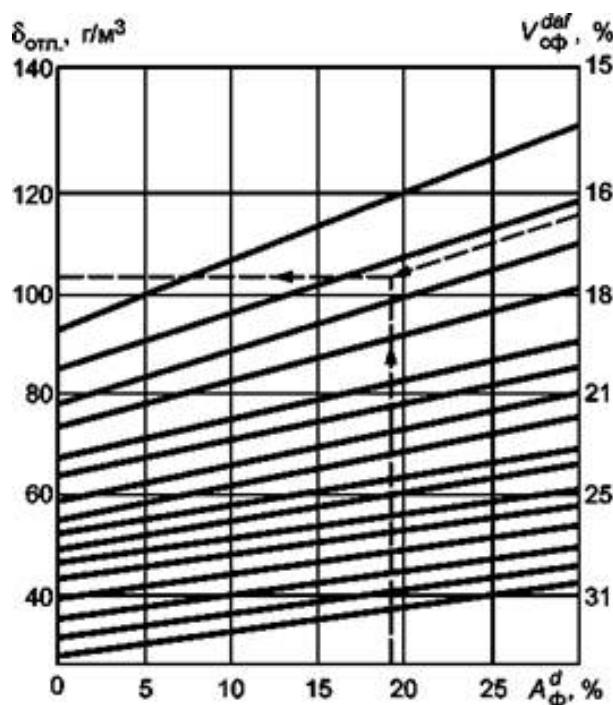
Рис. 38. Номограмма для определения нижних пределов взываемости отложившейся угольной пыли ( $\delta_{\text{отл}}$ )
