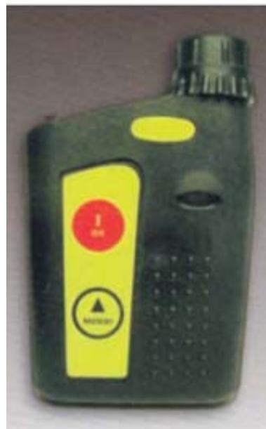
Рис. 13. Переносной газоанализатор
