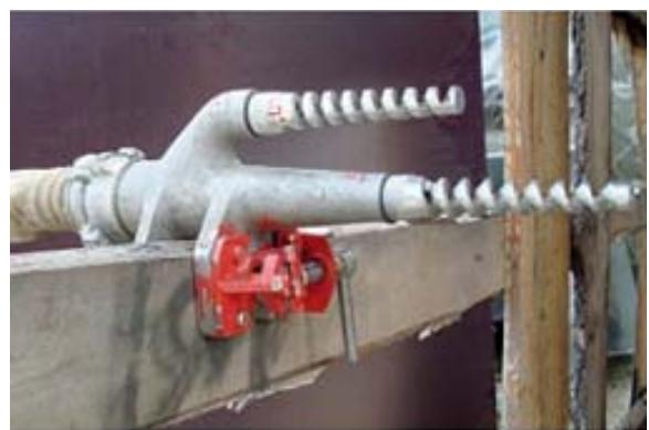
Рис. 11. Винтовой водоразбрызгиватель типа ВВР
