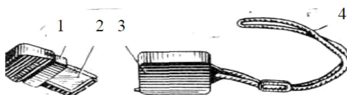
Рис. 3.6. Индивидуальный измеритель дозы
