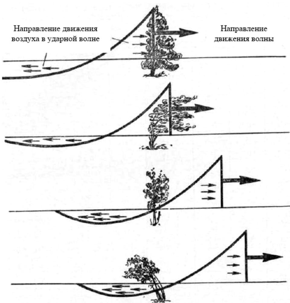
Рис. 1.5. Направление движения воздуха в ударной волне
