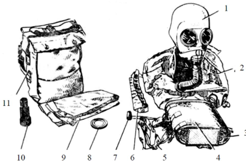
Рис. 2.11. Изолирующий дыхательный аппарат ИП-5:
