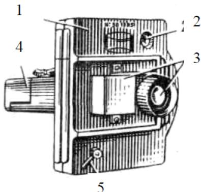
Рис. 3.9. Полевой колориметр ПК-56М:
