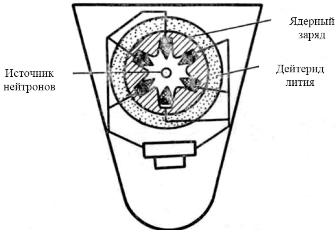
Рис. 1.3. Схема устройства термоядерного заряда типа «деление – синтез»
