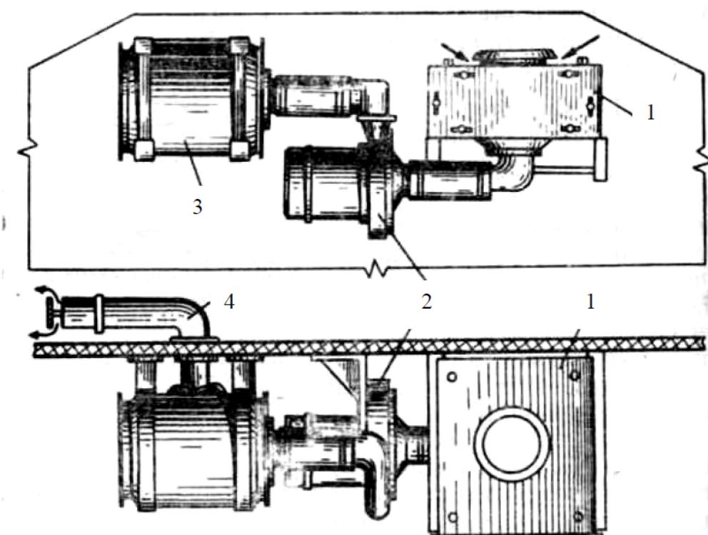
Рис. 2.20. Фильтровентиляционная установка ФВУА-100:
