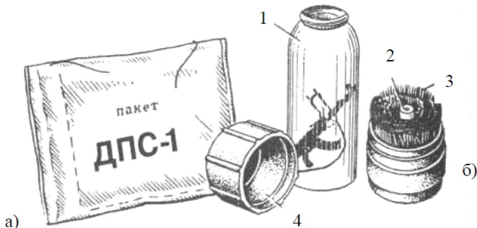
Рис. 2.15. Пакеты для дегазации оружия и обмундирования:
