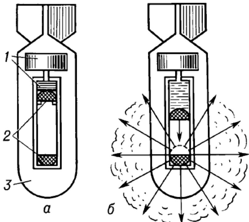
Рис. 1.1. Схема ядерного заряда пушечного типа
