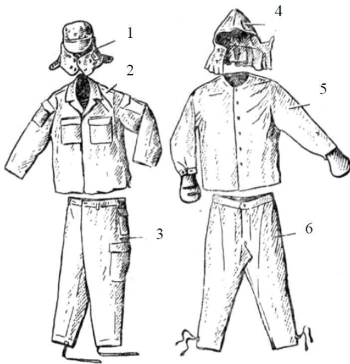
Рис. 2.13. Общевойсковой комплексный защитный костюм ОКЗК (ОКЗК-М):
