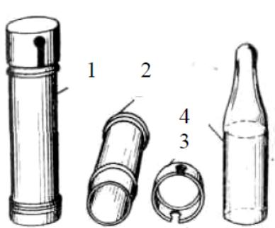
Рис. 3.8. Индивидуальный химический измеритель дозы ДП-70МП:
